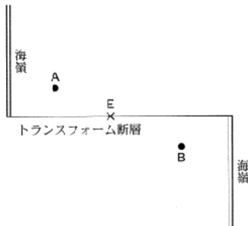
図2 海嶺(二重線)とトランスフォーム断層(単線) ×は震央の位置、●は観測点の位置を示す。
